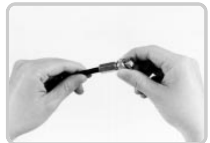
3. ケーブル外被部分もねじ込み完成。
