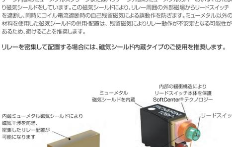
内蔵ミューメタル磁気シールドにより磁気干渉を防止、密集したリレー配置が可能になります
