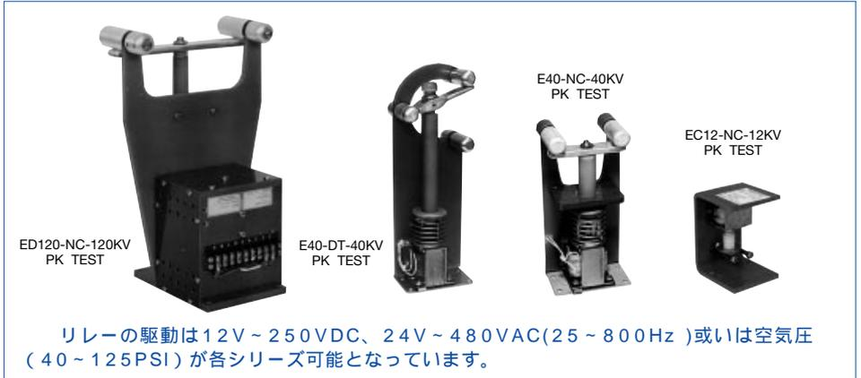
リレーの駆動は12V ~ 250VDC、24V ~ 480VAC(25 ~ 800Hz) 或いは空気圧(40 ~ 125PSI) が各シリーズ可能となっています。
