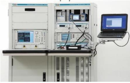
米国 Tegam 社では、様々な計測テクノロジーをベースに、校正専門/研究所グレードの RF/マイクロ波パワーセンサー校正システムをご提供しております。汎用的に使用されている大手メーカー様パワーセンサの校正が可能となり、日常の高精度な測定をサポート致します。ソフトウェアを含めた PMX システム、又はパワーメータ・パワースタンドード単体でご提供致します。
